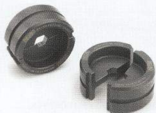
Okrúhle krimpovacie závitnice na krimpovanie DIN 46235 medených ôk a DIN 46267-1 konektorov
