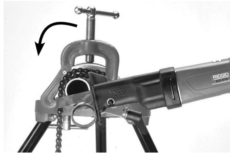
Figure 15C – Découpe du tube
