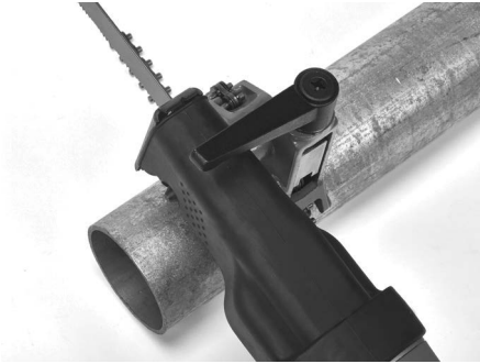
Figura 15B – Cortar o tubo
