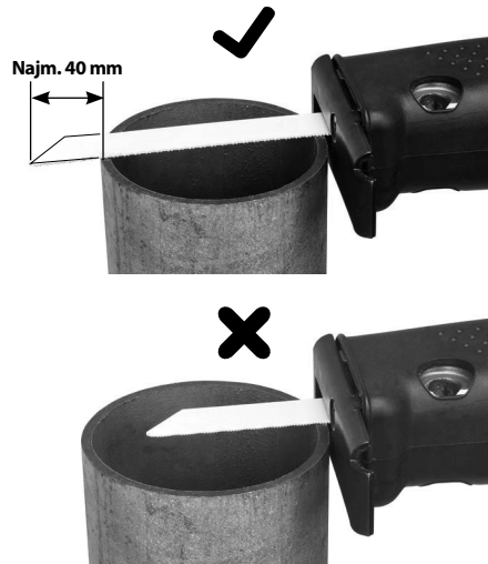
Slika 6 - Pravilna dolžina lista
