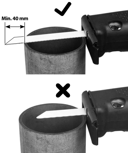
Figuur 6 – Juiste zaagbladlengte
