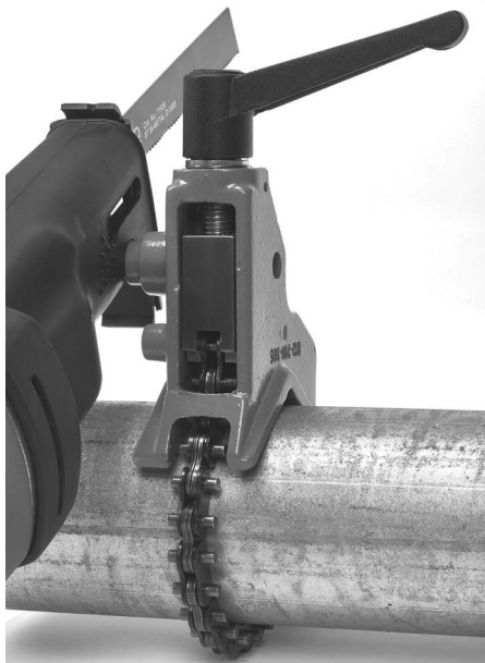
13. ábra – A fűrész felszerelése a támaszra
