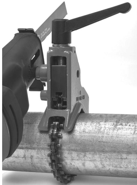
Slika 13 - Montaža žage na podporni napravi
