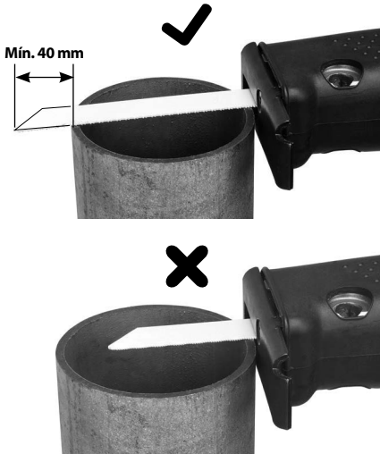
Figura 6 - Longitud adecuada de la hoja
