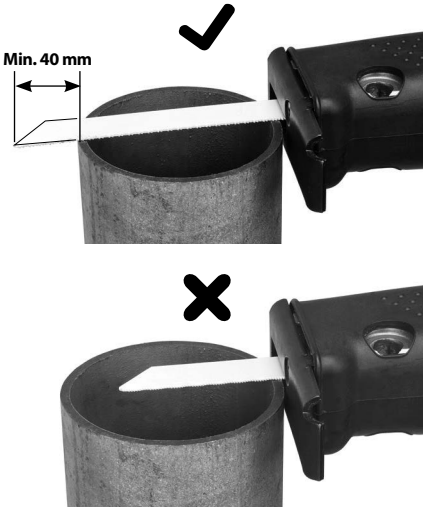
6. ábra – Megfelelő pengehossz
