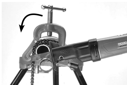
Рис. 15С- Резка трубы
