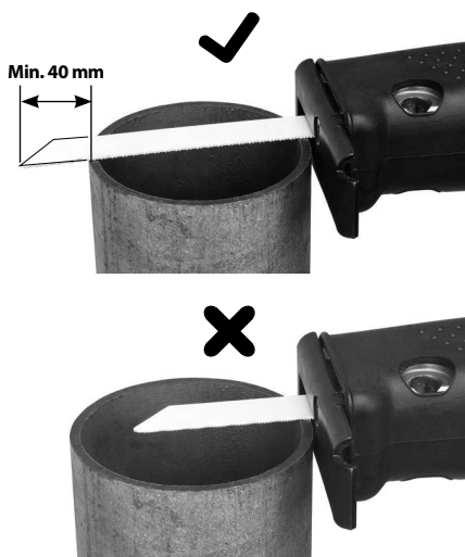
Ilustracja 6 – Prawidłowa długość brzeszczotu
