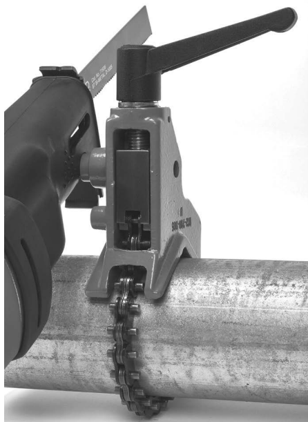
Рис. 13 - Установка пилы на фиксаторе
