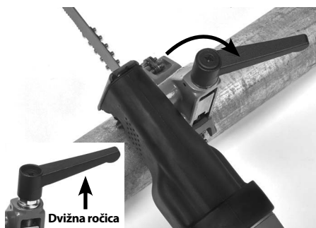
Slika 14 - Nastavljanje ročice objemke
