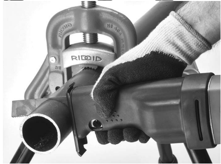
Obrázok 16 – Rezanie voľným držaním píly
