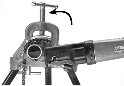
Obrázok 15B– Rezanie rúry
