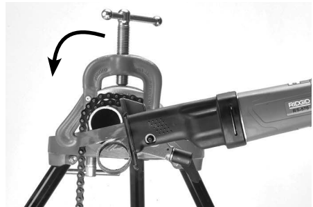
Abbildung 15C– Schneiden des Rohrs
