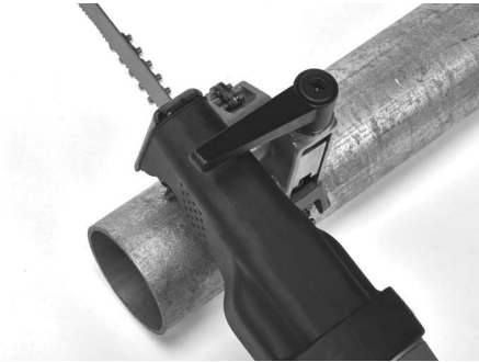
Figura 15A– Taglio del tubo
