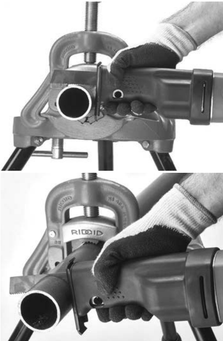
Figure 16 – Découpe à main levée Découpe en plongée
