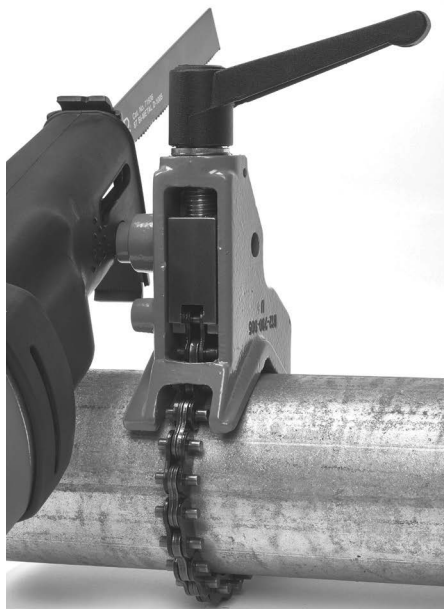
Figura 13 – Montaggio del seghetto sul Dispositivo di supporto
