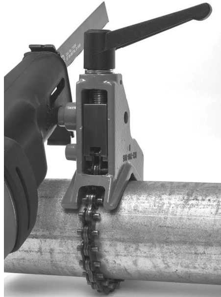
Εικόνα 13 – Τοποθέτηση του ταχυπρίονου στον μηχανισμό αντιστήριξης
