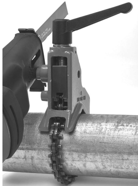
Kuva 13 – Sahan kiinnittäminen tukilaitteeseen
