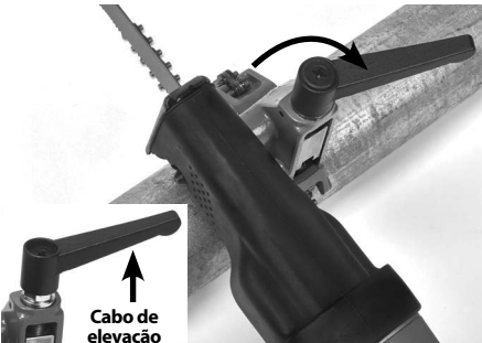
Figura 14 – Ajuste do cabo de fixação
