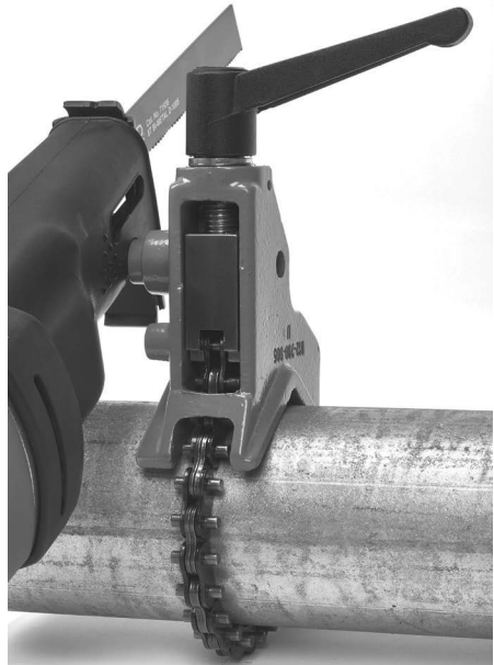
Obrázek 13 – Montáž pily na podpěrné zařízení
