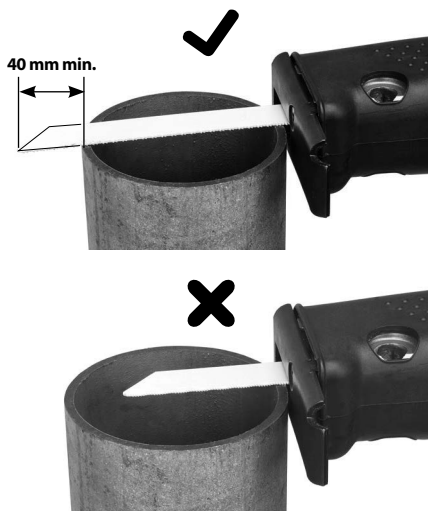
Figure 6 – Longueur de lame adéquate
