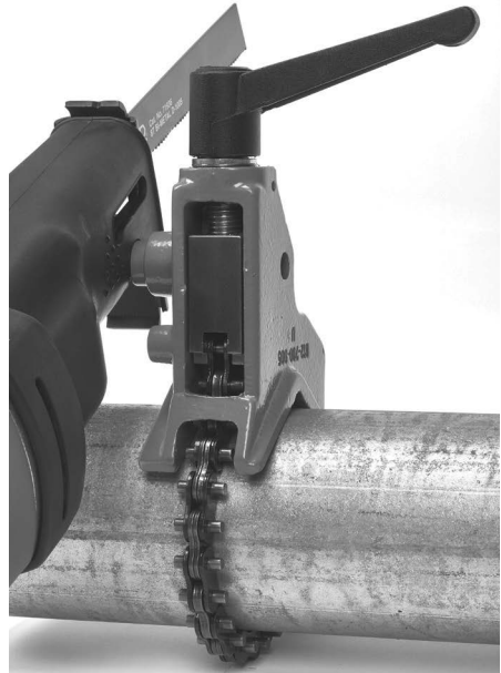
Figure 13 – Fixation de la scie sur le dispositif de support
