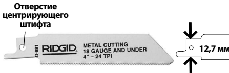
Рис. 5А - Полотна для пил с одинарным хвостовиком
