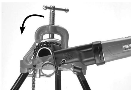
Figur 15C– Skjæring av røret
