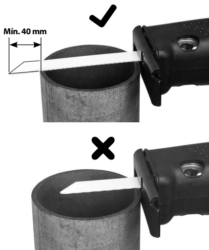
Figura 6 – Comprimento adequado da lâmina
