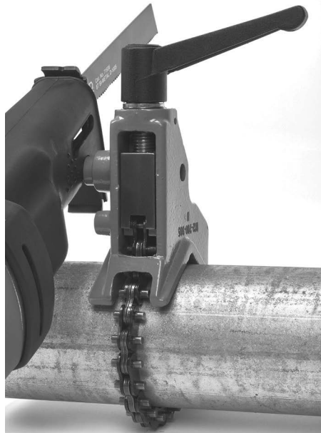
Slika 13 – Montaža testere na uređaj za oslanjanje
