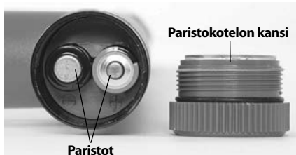
Kuva 7 – Paristojen vaihtaminen (vastaanotin)
