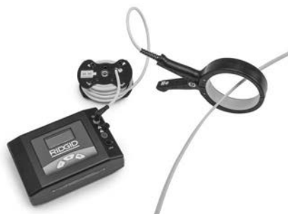
Figur 14 – Induktiv klemme festet til en leder
