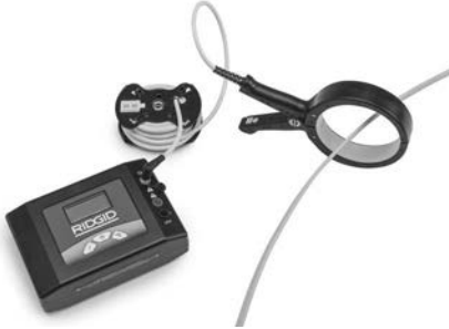
Rysunek 14 - Opaska indukcyjna podłączona do przewodu
