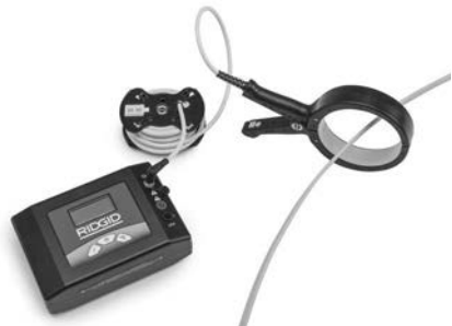
Figur 14 – Induktiv klemme fastgjort til en leder
