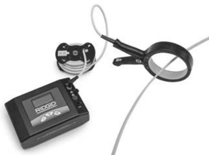
Figura 14 – Clemă inductivă atașată la un conductor
