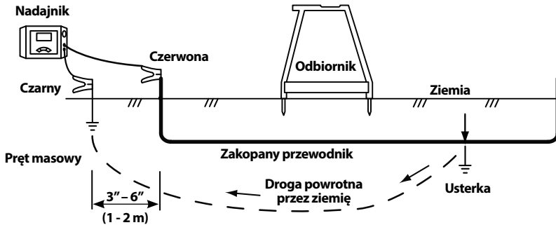
Rysunek 8 - Podłączenia nadajnika do znajdowania usterek
