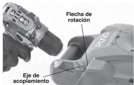
Figura 4 – Conexión del taladro al eje de acoplamiento
