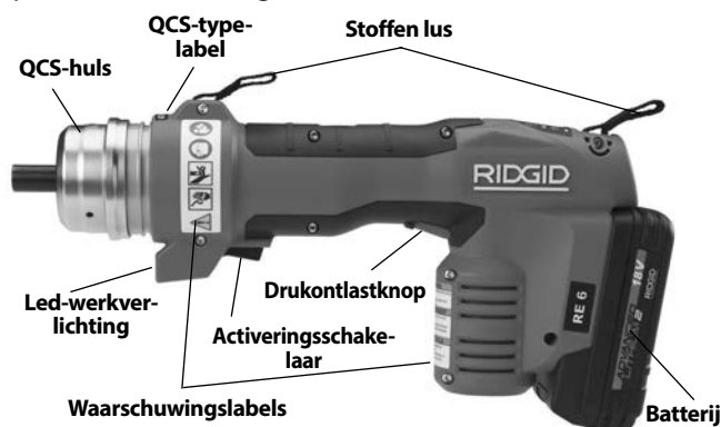
Figuur 1 – RE 6/RE 60 – Gebruik de QCS-koppeling voor het bevestigen van de wisselkoppen
