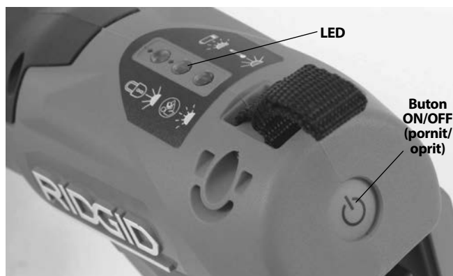
Figura 3 – Lumini de stare mașina-unelă
