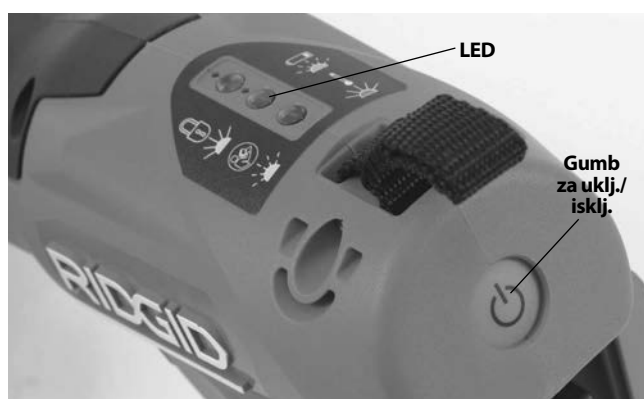
Slika 3 - Svjetla statusa alata
