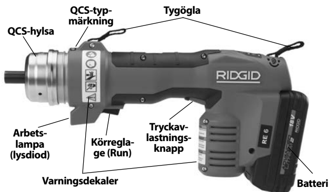
Figur 1 – RE 6/RE 60 – Använd QCS-koppling för huvudanslutning
