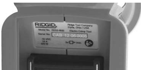
4. ábra – A gép sorozatszáma - Az első 4. számjegy (bekarikázva) mutatja a gyártás évét és hónapját. (12 = év, 06 = hónap).
