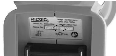
Figure 4 – Numéro de série de l'appareil – Les 4 premiers chiffres (encerclés) indiquent l'année et le mois de fabrication. (12 = année, 06 = mois).
