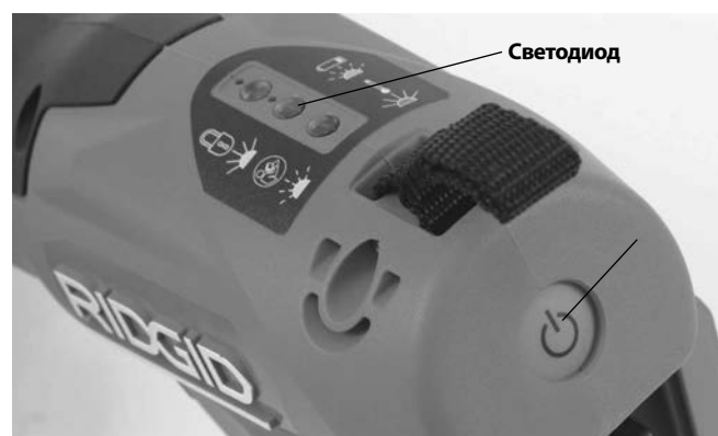
Рис. 3 – Индикаторы состояния инструмента
