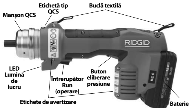
Figura 1 – RE 6/RE 60 - Utilizarea cuplajului QCS pentru atașarea capului
