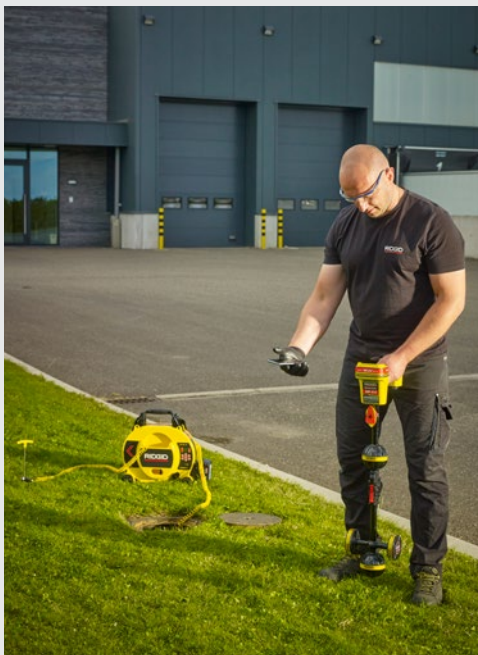
Použijte přijímač SR-24 k bezdrátové změně vysílané frekvence na vysílači ST-33Q+
