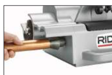
Vnitřní odhrotovač odstraní bez námahy otřepy, které by způsobily turbulentní proudění
